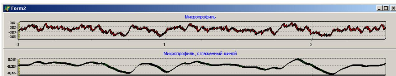
Рис. 2. Компьютерное моделирование микропрофиля, сглаженного шиной 12,00-18
